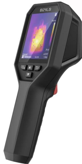
HIKMICRO B21LS è progettata per la misurazione della temperatura al fine di individuare guasti invisibili. È dotata di un rilevatore termico con risoluzione 256 x 192 e di un rilevatore ottico da 2 MP. L'intervallo di misurazione termografica va da -20°C a 550°C (-4°F a 1022°F), coprendo la maggior parte delle situazioni.
